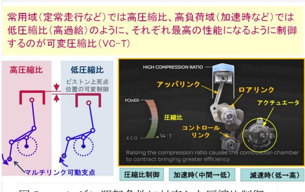
VC-Tはマルチリンク方式で、過去の事例(付録1参照)をみても、敢えてこの方式をクランクに適用した例は少な
