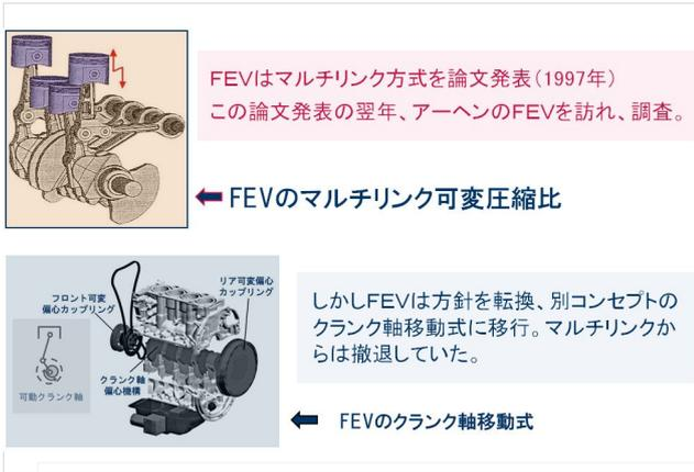
図4 FEV Europe GmbHの可変圧縮比機構
