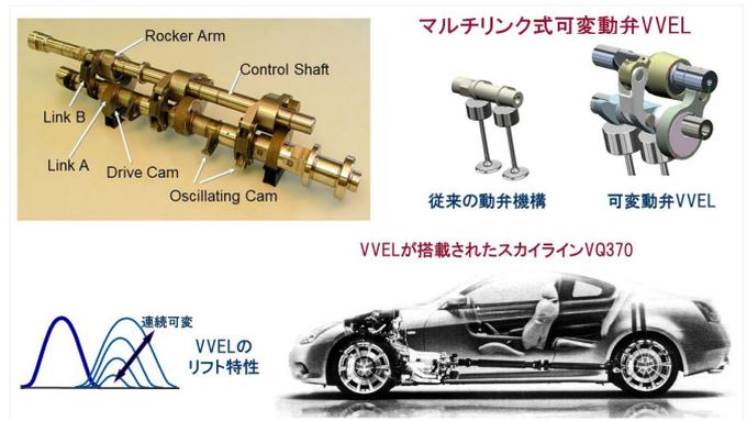
図 A-3 リフト&作動角連続可変動弁 VVEL
