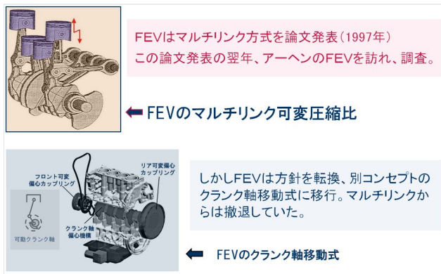
図4 FEV Europe GmbHの可変圧縮比機構
