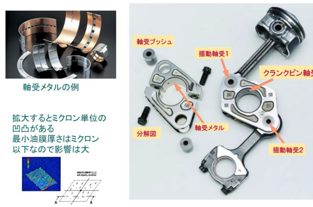
図14 3つの大荷重軸受をロアリンクに集約
