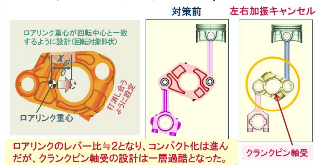
図12 ロアリンクの左右加振力の分析と低減策
